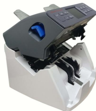
(B) Wyczyść czujniki i tor banknotów
